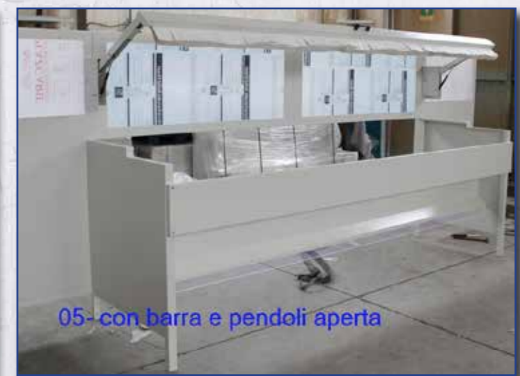
Porta basculante con molle a gas
