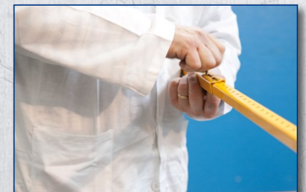
Accorciatura del tirante telescopico.
