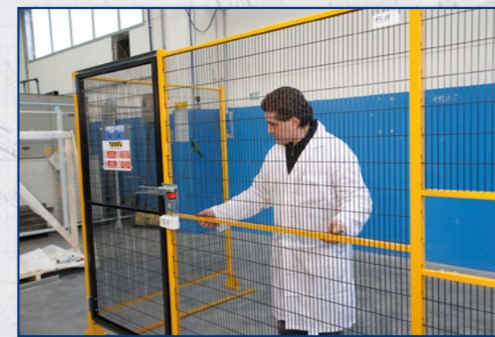
Il tirante serve per bloccare la rete al montante.
