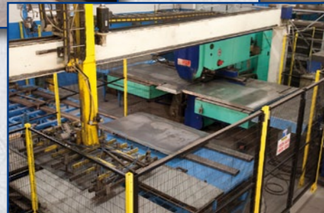
Punzonatura Tecnotransfer 15SF campo di lavoro X 3000 Y 1500, spessori di taglio da 1 a 6 mm
