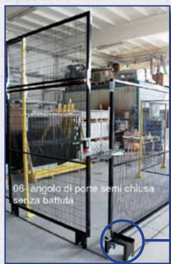
Scorrevole con guida a terra ad angolo libero
