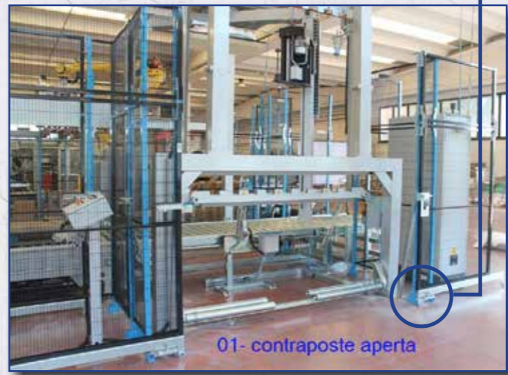
Scorrevole SOSPESA contrapposta (senza guide sopra e sotto)
