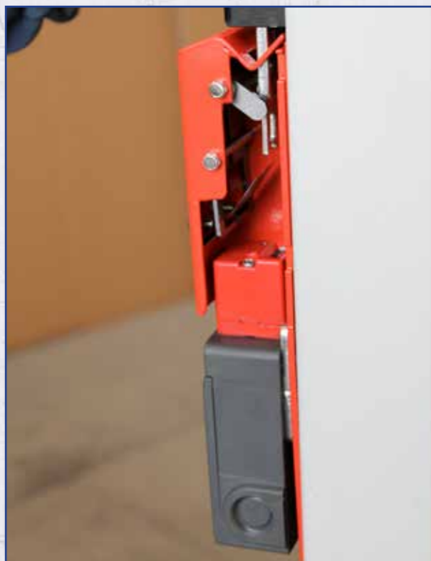
Solo la sua maniglia apre le due coperture che permettono di entrare nel micro
